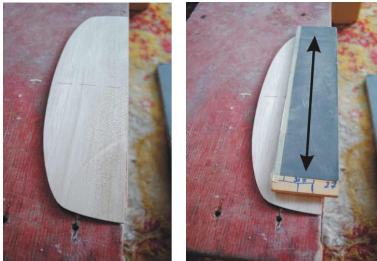
**ИЗЛАЗНА ИВИЦА** КРИЛА СЕ ПОСТАВИ НА РАВНУ РАДНУ ПОВРШИНУ, ПОРАВНА СА ИВИЦОМ РАДНЕ ПОВРШИНЕ И БРУСИ ПРВО СА БРУСНИМ ПАПИРОМ 100, ЗАТИМ 200 И 600, ДОК НЕ ПОРАВНАМО СВЕ НЕРАВНИНЕ И ДОБИЈЕМО ИЗЛАЗНУ ИВИЦУ ОКО 0,5 мм
